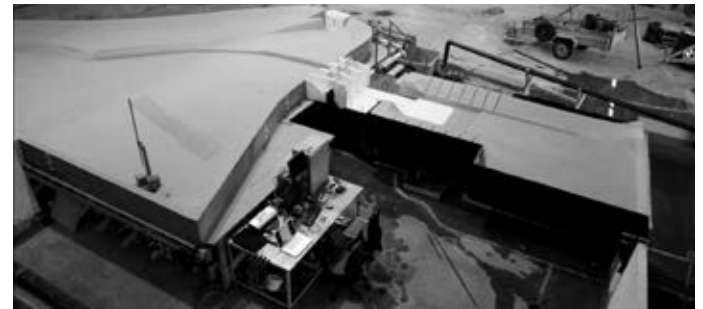
Mynd 3: Straumfræðilíkan Hvammsvirkjunar í verklegri aðstöðu Siglingastofnunar Íslands. Fyrir miðri mynd má sjá lokuvirki með geiralokum og iðuþró neðan við lokuvirkið (hvítt á myndinni). Efst á myndinni fyrir miðju sést inntak stöðvarhúss (einnig hvítt á litinn).
